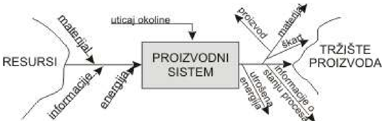
Slika 1. Shematski prikaz proizvodnog sistema
